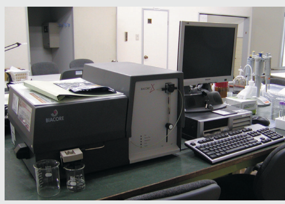
図2 定量PCR装置と生体分子間相互作用解析装置
