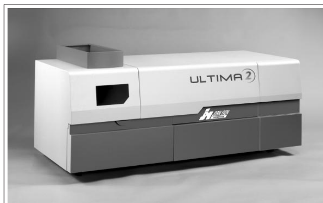
図3 ICP発光分析装置 ULTIMA 2
