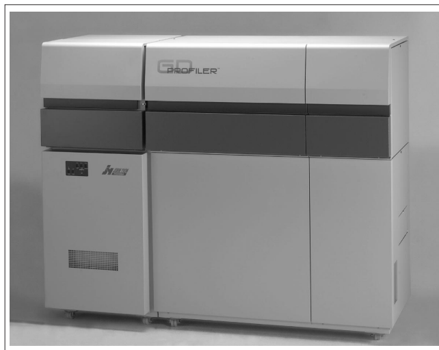
図1 高周波グロー放電発光表面分析装置 GD-PROFILER
