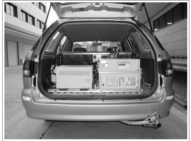
図2 車載型排ガス計測システム(OBS-1000)の車両への搭載例
