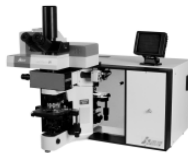
図1 ラマン・赤外線一体型顕微分光装置 LabRam-IR
