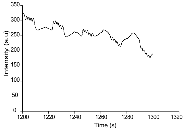
図8 エッチング完了時の強度
