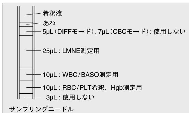
図6 PENTRA60 < LC-5000 > のサンプル吸引量と用途
