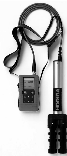
図1 マルチ水質モニタリングシステム U-23 The U-20 Series Multi-water Quality Monitoring System
