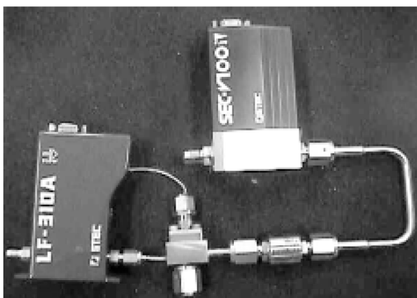
図1 試作した気液混合型の気化器 New liquid vaporization system
