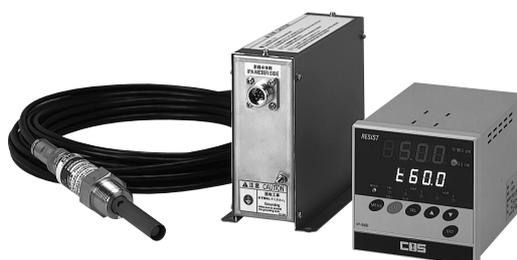
最近、半導体プロセスにおける蒸気乾燥工程では、純度の高いIPA(isopropyl alcohol)が主に使われています。このたび、コスでは、水分やイオン性不純物がIPAに混入すると比抵抗が低下する現象を利用して、IPAの純度を監視するIPA比抵抗計“IP - 960”を製品化しました。本器は、増幅器を内蔵させた交流2極法の検出器を使い、IPAの比抵抗を正確かつ安定に測定することができます。蒸気乾燥装置やIPAリサイクル・システムに直結し、IPA純度の連続モニタとして今後の活躍が期待されています。
