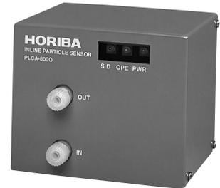
PLCA-800は半導体プロセスで用いられる様々な液体中の微粒子を連続的に測定・監視するためのインライン・パーティクルセンサです。PLCA-800は、高出力半導体レーザーの散乱光を測定することにより、液体中の最小0.2  $\mu\text{m}$ までの微粒子を、連続して安定に検知することができます。半導体デバイスは、純水や薬液 / レジストなどの微粒子が存在すると生産歩留まりが極端に低下します。コンパクトなケースにまとめられたPLCA-800をプロセスに直接設置し、微粒子を常時監視することにより、デバイス製造の大幅な歩留まり向上、コストダウンに役立ちます。
