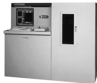
本装置は、露光用レティクルやマスク上の異物を高感度に検出し、その位置を高精度に特定し画像に表示します。本装置は、アルゴンによるレーザ散乱方式を採用することにより、最小検出  $0.35 \mu\text{m}$  の異物を 90% 以上の検出率で測定できます。また、各種のマスクケースに対応する多段ソーヤや各種通信機能を充実させるなど、あらゆる半導体製造ラインに即応できる構成となっています。
