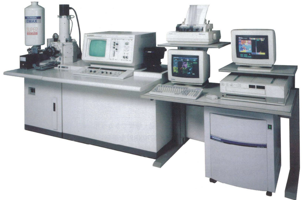
図1 エネルギー分散形X線マイクロアナライザ EMAX-5770 XRP (日立製作所 走査電子顕微鏡S-2400と組み合わせたもの) Energy dispersive X-ray micro-analyzer EMAX-5770 XRP (A combination with scanning electron microscope S-2400 manufactured by Hitachi, Ltd.)
