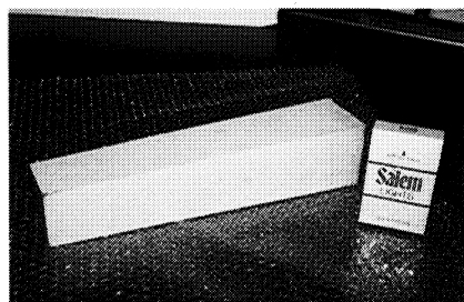
図1 コーネル大学向け大型CsI(Tl)シンチレーター Large-scale CsI(Tl) scintillator at Cornell University
