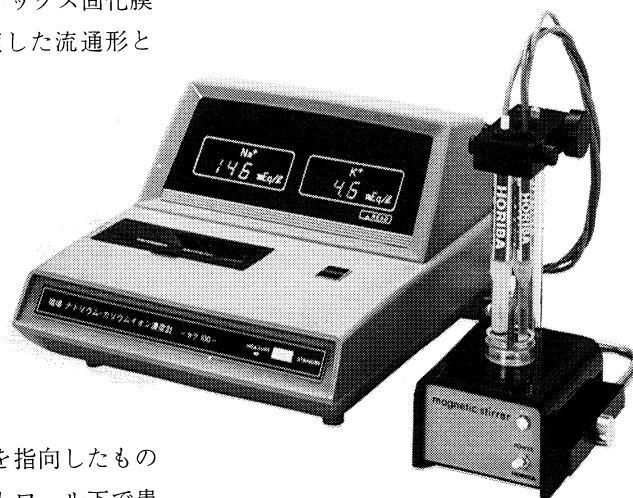
図13 初期の電解質分析装置 (SERA-100) The SERA-100, an early model Horiba blood electrolyte analyzer
