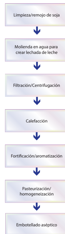
Figura 1 Procesamiento comercial típico de la leche de soja
