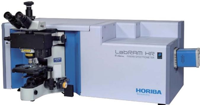
图5. HORIBA LabRAM Evolution 高分辨拉曼光谱仪
