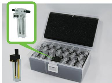
Dos tipos de celdas de medición de potencial zeta (Para medición del potencial zeta y del tamaño de partícula, 100 µL, muestra acuosa y solvente orgánico)
