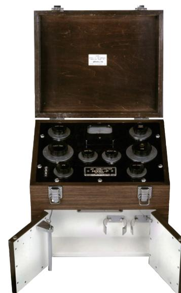
図1 P型pH計(復元モデル)
